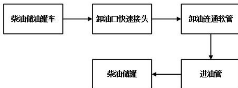
图 2.6-2 柴油卸油流程图
