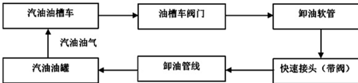
图 2.4-1 乙醇汽油卸油及油气回收工艺流程示意图
