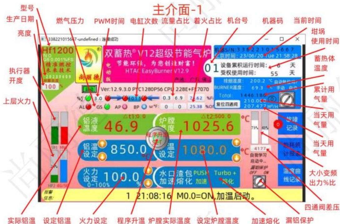
图 2.3-5 天然气自动浇注线操作控制台液晶显示屏显示图
