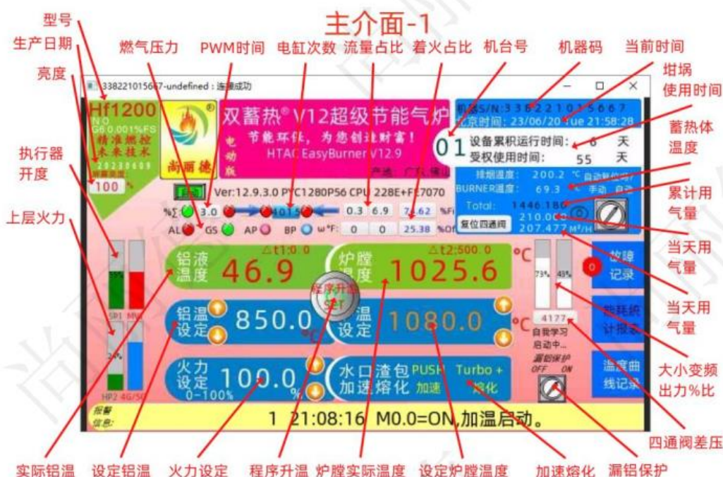
图 2.4-2 天然气自动浇注线操作控制台液晶显示屏显示图
