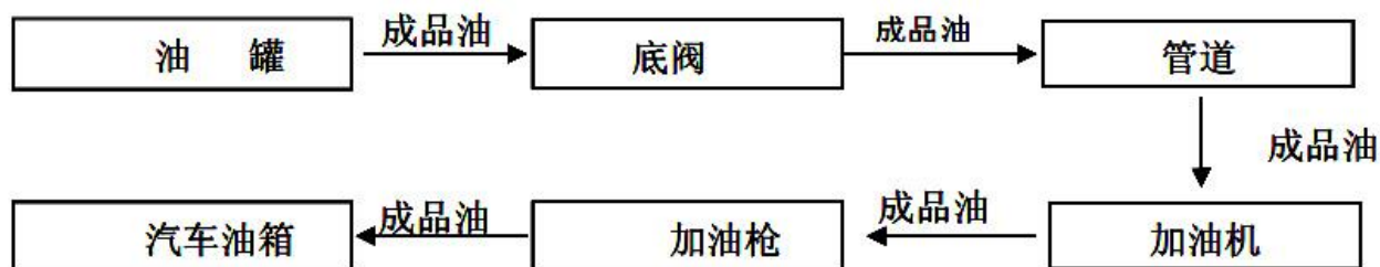
图2.6-3 柴油加油工艺流程示意图
