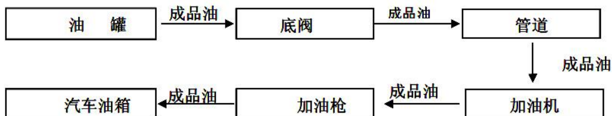
图 2.6-3 柴油加油工艺流程示意图
