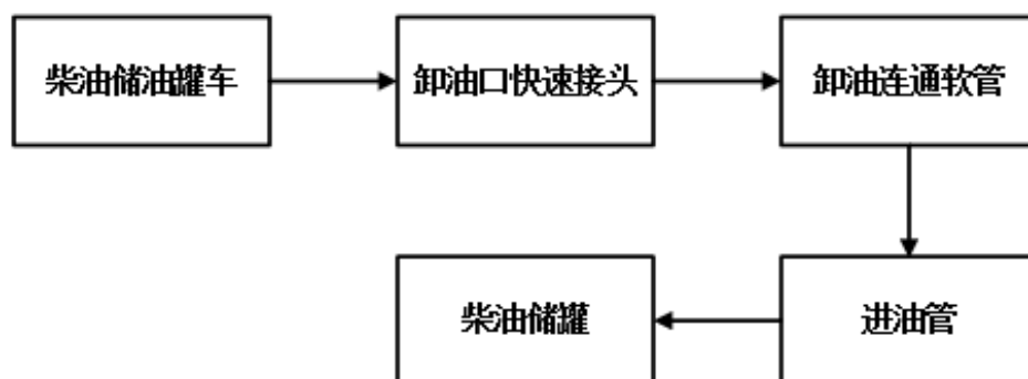
图 2.6-2 柴油卸油流程图
