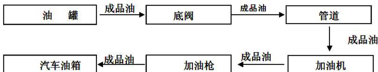
图 2.6-3 柴油加油工艺流程示意图
