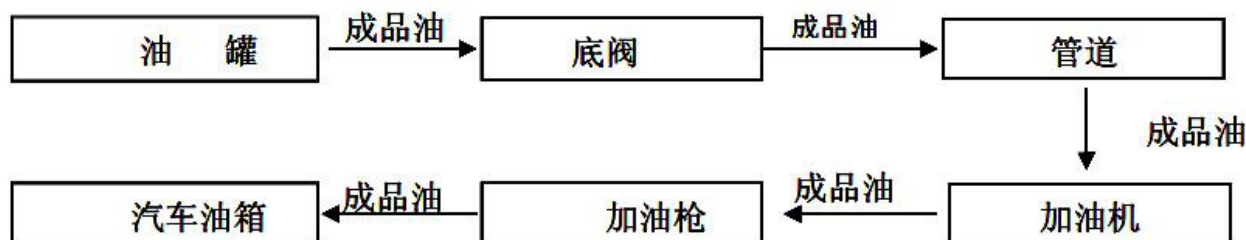
图 2.6-3 柴油加油工艺流程示意图
