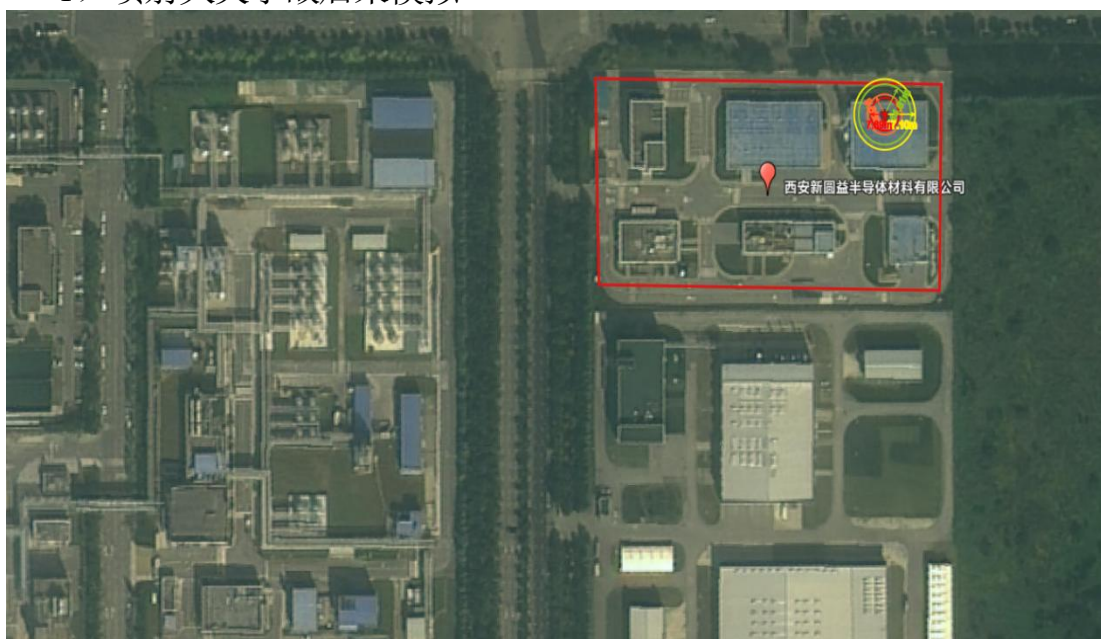
图 5.2-10 中孔泄漏后发生喷射火灾影响的区域
