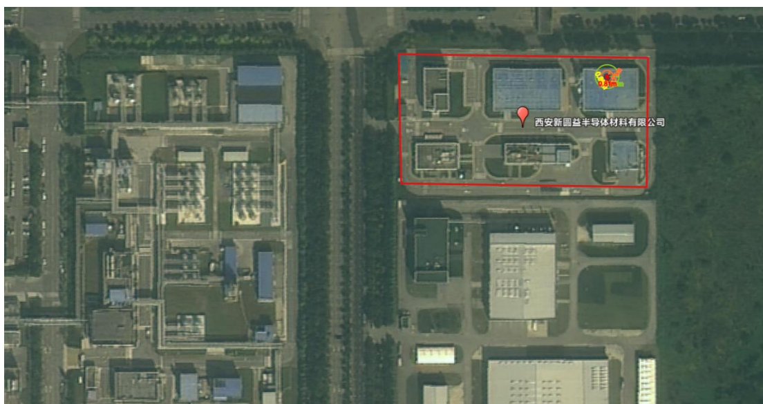
图 5.2-14 完全泄漏后发生蒸汽云爆炸影响的区域
