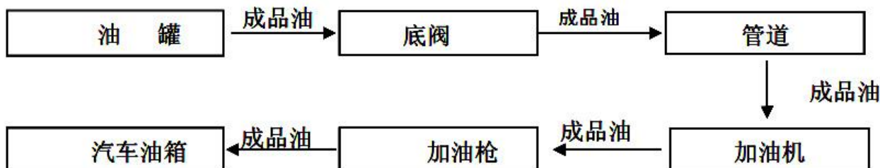
图 2.6-3 柴油加油工艺流程示意图
