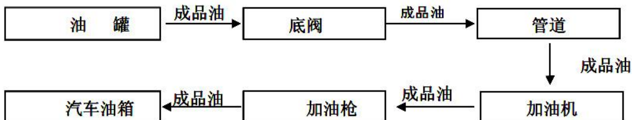
图 2.6-3 柴油加油工艺流程示意图
